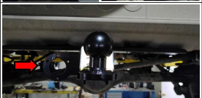
**ШАГ 3.** Установите съемный шар (поз. 9) закрепив его пальцем (поз. 5) и шплинтом (поз. 13). Закрепите съемный шар болтами M12 (поз. 10) через шайбы 12 и пружинные шайбы 12 (поз. 11, 12) как указано на схеме в паспорте.
