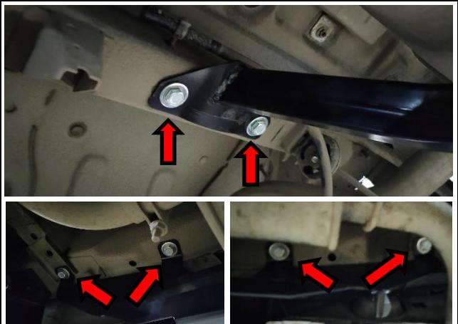
**ШАГ 2.** Установите кронштейн розетки (поз. 6) и закрепить ее гайкой M8 (поз. 7) через шайбу 8 пружинную (поз. 8). Подключите электрику: розетку, жгут проводов, блок согласования (если требуется).
